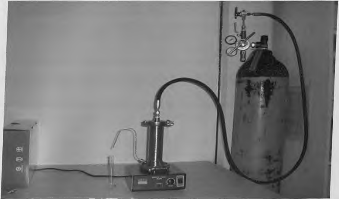
Rajah 3.5 Eksperimen ketelapan menggunakan sel penuras hujung tertutup dengan tekanan diantara 4 bar ke 20 bar
