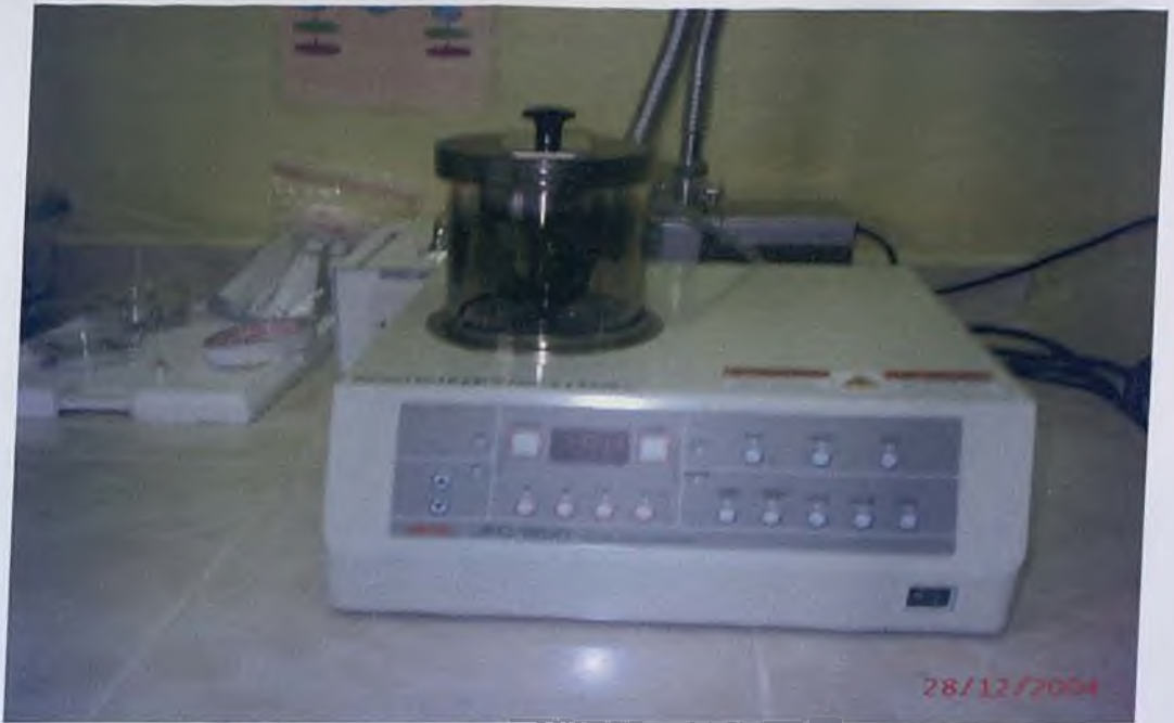
Rajah 3.6 Autocoater (model JFC 1600) yang digunakan untuk menyembur dan meliputi bahagian membran dengan lapisan emas nipis
