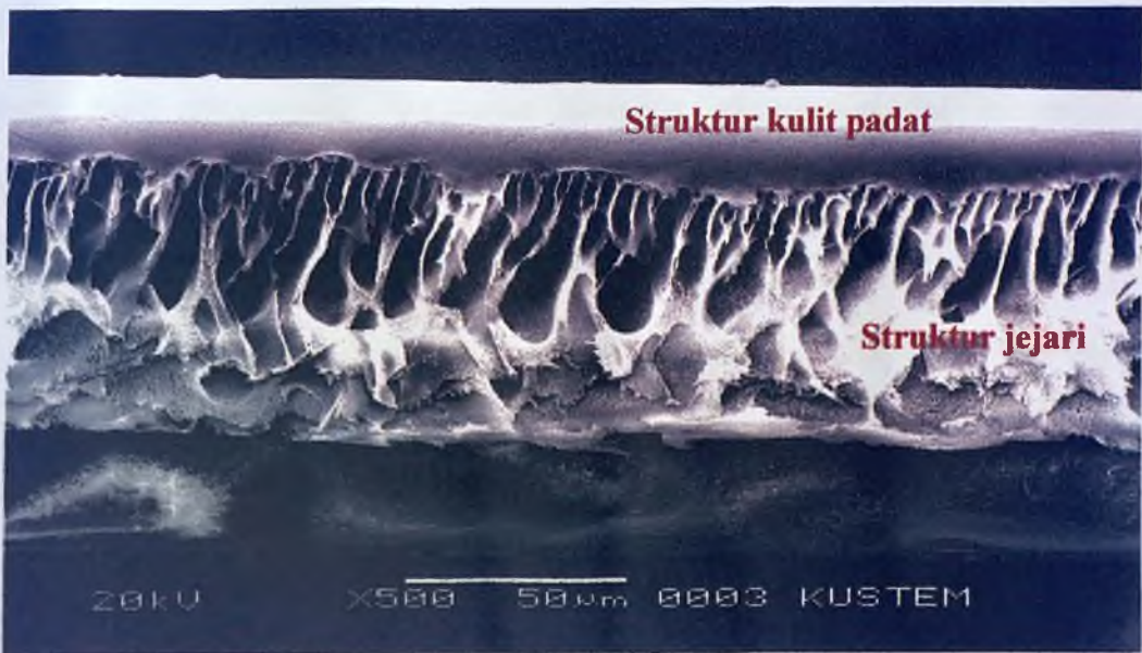
Rajah 4.13 Morfologi membran PSf. Daripada komposisi ketiga yang mengandungi PSf/NMP/PVP: 18/75/7 dan menggunakan teknik fasa balikan basah dan kering.
