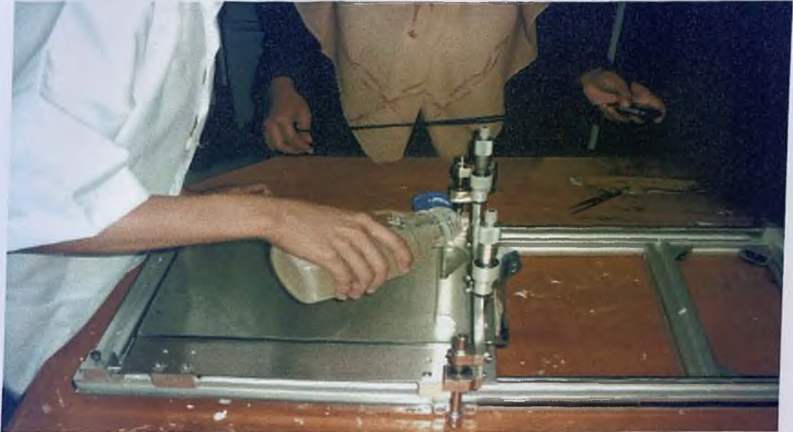
Rajah 3.2 Proses pengacuan larutan membran menggunakan mesin pengacu
