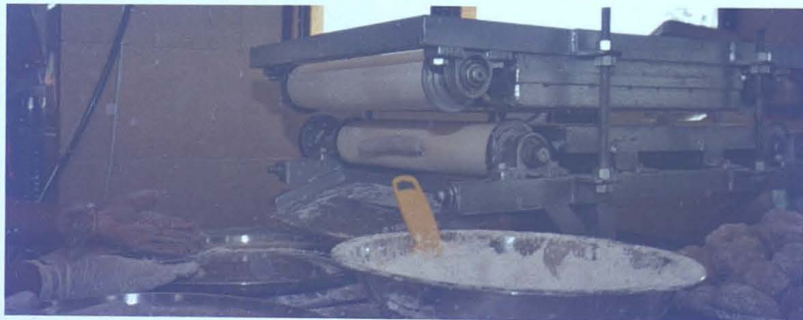
Keropok lekor is coated with some flour to avoid sticking to each other Die Keropok Lekor werden mit etwas Mehl beschichtet um zu verhindern, dass sie sich miteinander verkleben.
